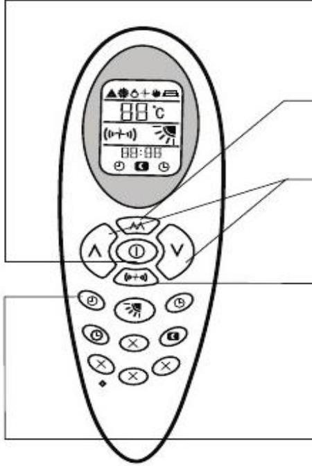
1 Appuyez sur la touche **MARCHE/ARRET** pour mettre sous tension le climatiseur. L'appareil va fonctionner sous le mode précédemment mémorisé.
