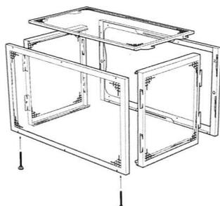
2- Les panneaux se solidarisent ensemble grâce au système d'emboîtement
