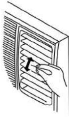
Pour ajuster la direction verticale du courant d'air, ajuster la position d'une des lames des persiennes horizontales. Garder toujours la lame la plus haute et la lame la plus basse à l'horizontal afin d'empêcher les gouttes de condensation de couler sur le panneau avant.
